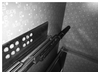
4. Prüfen, ob die Laschen der Gleitschienen aussehen wie auf dem Bild.
