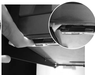
2. Appuyer sur les pinces. Elles doivent rester dans la position indiquée.
